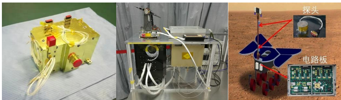
从左至右：多光谱相机、火星表面成分探测仪、磁场探测仪
