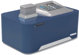
基于变温谐振集成微悬臂梁的分析仪器技术 中国科学院上海微系统与信息技术研究所、厦门海恩迈科技有限公司
